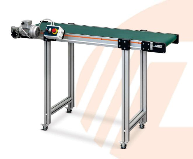
I nastri trasportatori Movitek Serie **MT-PNS** sono progettati per adattarsi a diversi utilizzi nel settore industriale. Realizzati in alluminio anodizzato, vengono forniti completi di tela di movimentazione, gambe di supporto ad angolazione variabile con ruote girevoli, motoriduttore ed impianto elettrico Start&Stop con regolatore di velocità;
