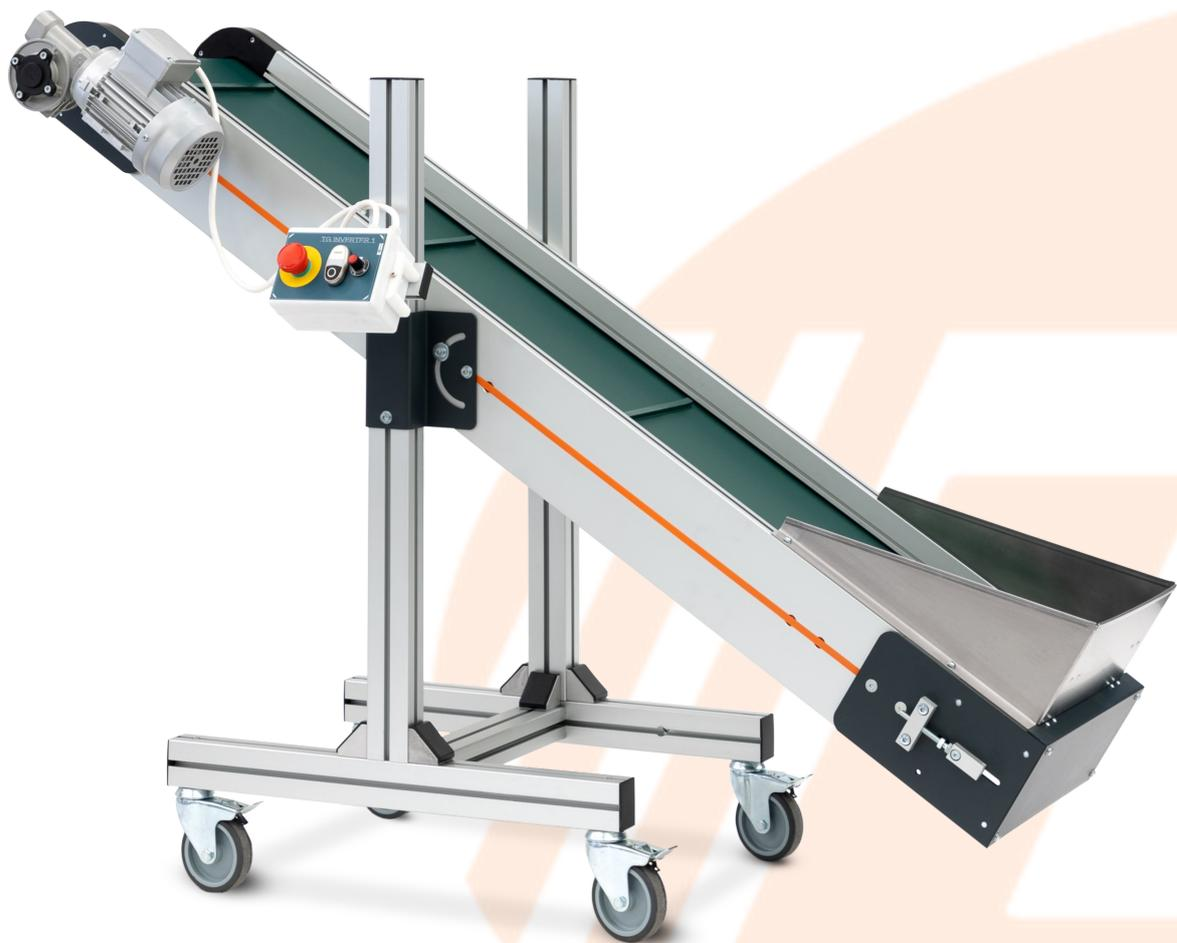
I nastri trasportatori Movitek Serie **MT-I** sono progettati per adattarsi a diversi utilizzi nel settore industriale. Realizzati in alluminio anodizzato, vengono forniti completi di tela di movimentazione, gambe di supporto ad angolazione variabile con ruote girevoli, motoriduttore ed impianto elettrico Start&Stop con regolatore di velocità ;
